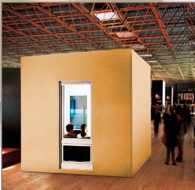
Schallschutzkapselung von Besprechungsräumen mit Silent- board in Kombination mit der Raum-in-Raum-Bauweise Cubo.
